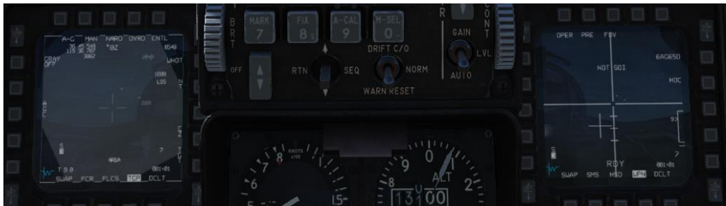
Zuerst wird der Sensor des TGP bewegt, somit das System Delta erzeugt und der SPI bewegt. Der AGM-65-Sucherkopf folgt dem SPI.
